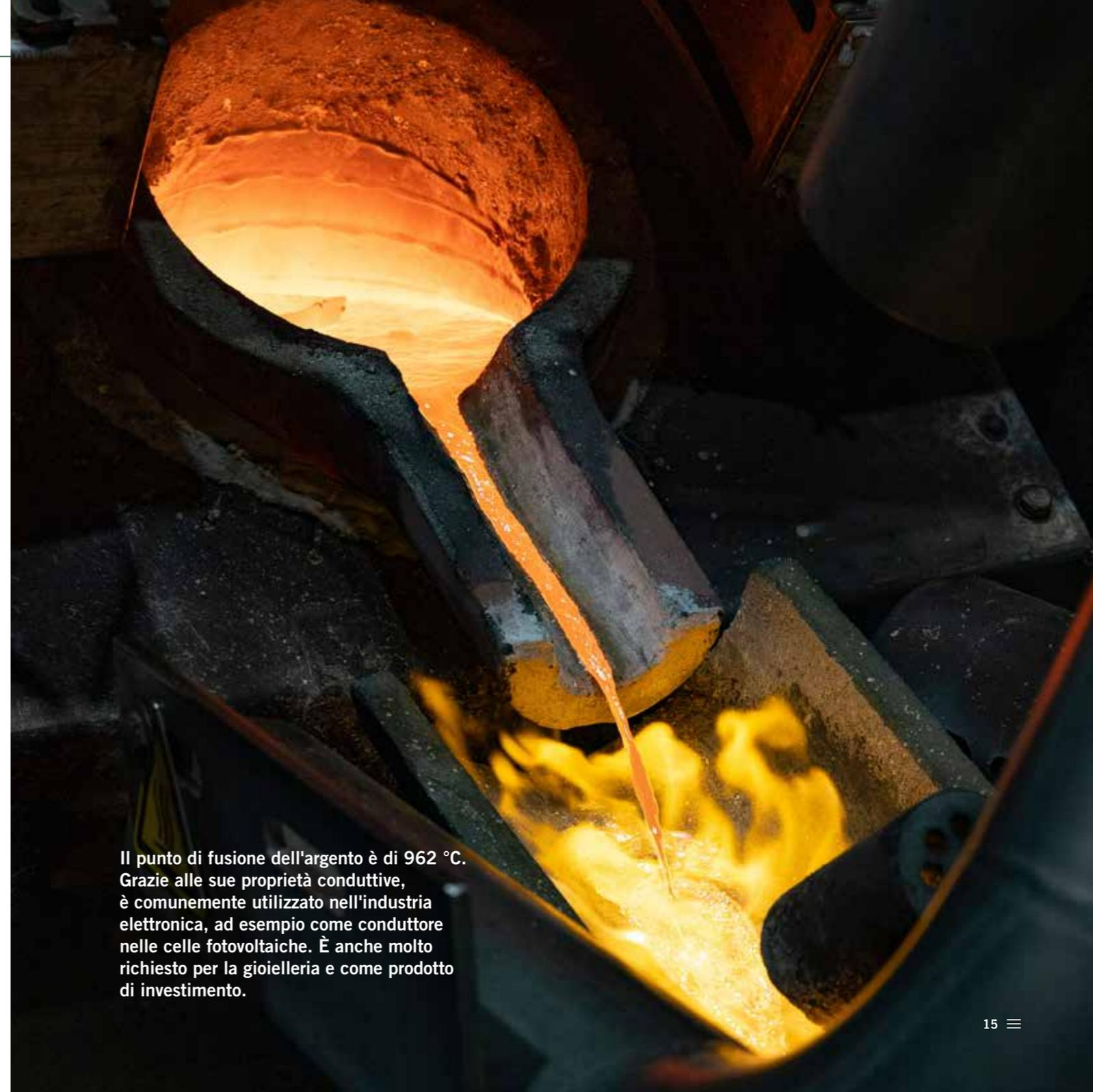
Il punto di fusione dell'argento è di 962 °C. Grazie alle sue proprietà conduttive, è comunemente utilizzato nell'industria elettronica, ad esempio come conduttore nelle celle fotovoltaiche. È anche molto richiesto per la gioielleria e come prodotto di investimento.
