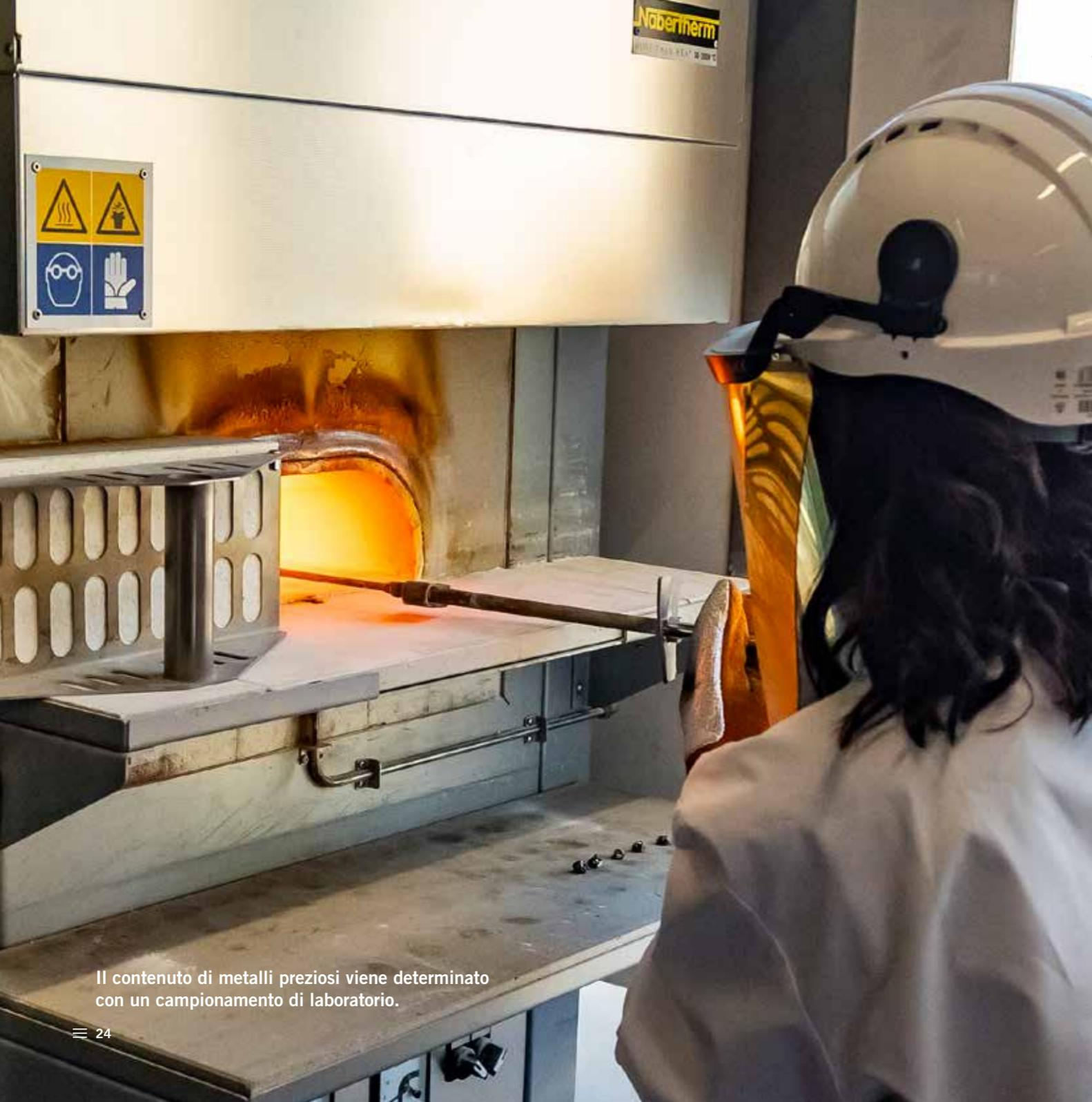
Il contenuto di metalli preziosi viene determinato con un campionamento di laboratorio.
